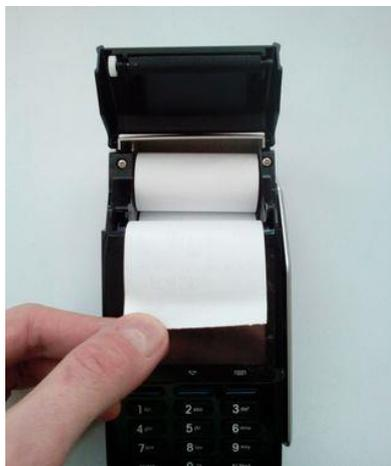
Рисунок 4. Загрузка рулона в лоток принтера
