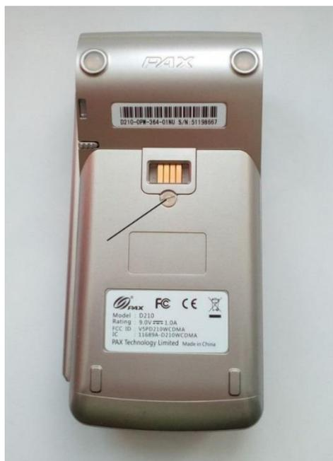
1. Выкрутите винт на задней крышке терминала и снимите ее
